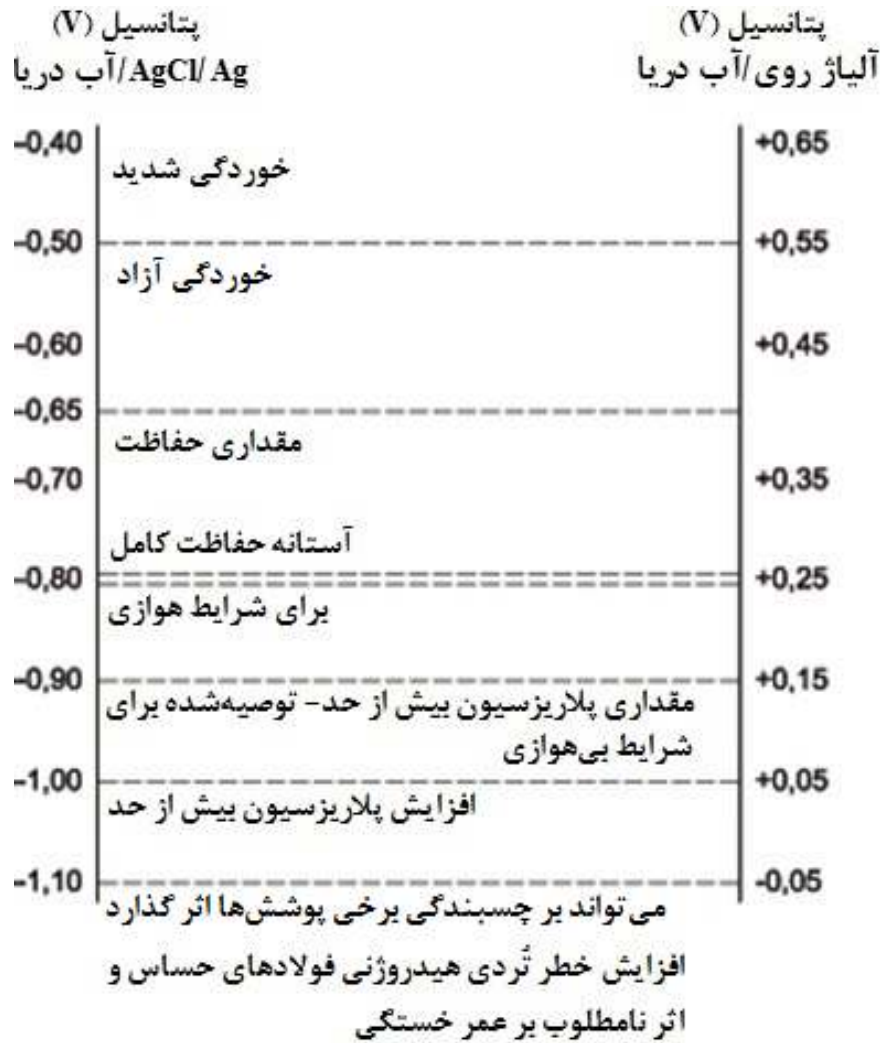
شکل ۳- الگوهای خوردگی، حفاظت کاتدی و پلاریزه شدن بیش از حد فولاد به عنوان تابعی از پتانسیل الکتروود مرجع
