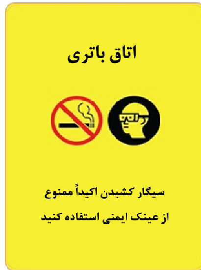
شکل ۲۲- نمونه تابلوی ایمنی اتاق باتری
