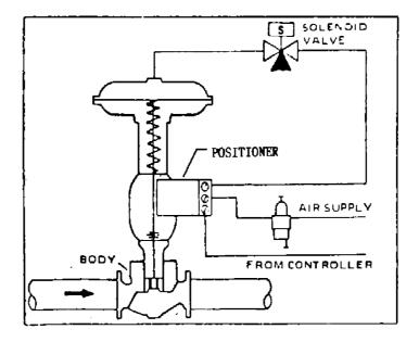
TYPICAL APPLICATION OF A SOLENOID VALVE Fig. 27
